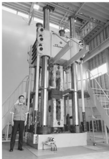
日立南試験所に新たに導入した1000ト油圧サーボ疲労試験機
