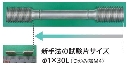
■ミニチュア試験片を使用した単軸クリープ試験が実施可能です
