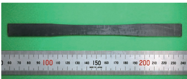
ASTM C1275に基づき製作したフルサイズ試験片の外観写真
