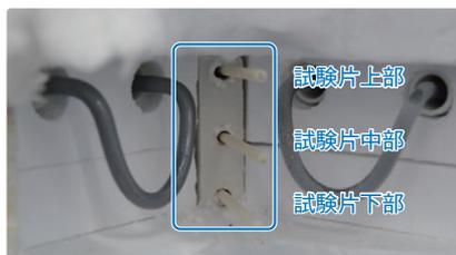
試験片温度計測用熱電対
