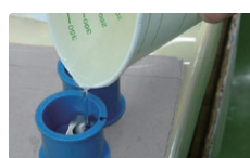
試料の樹脂包埋の様子
