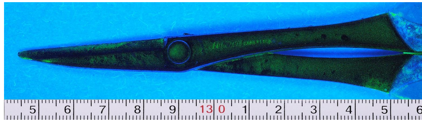
健全刃 表の MT 状況
