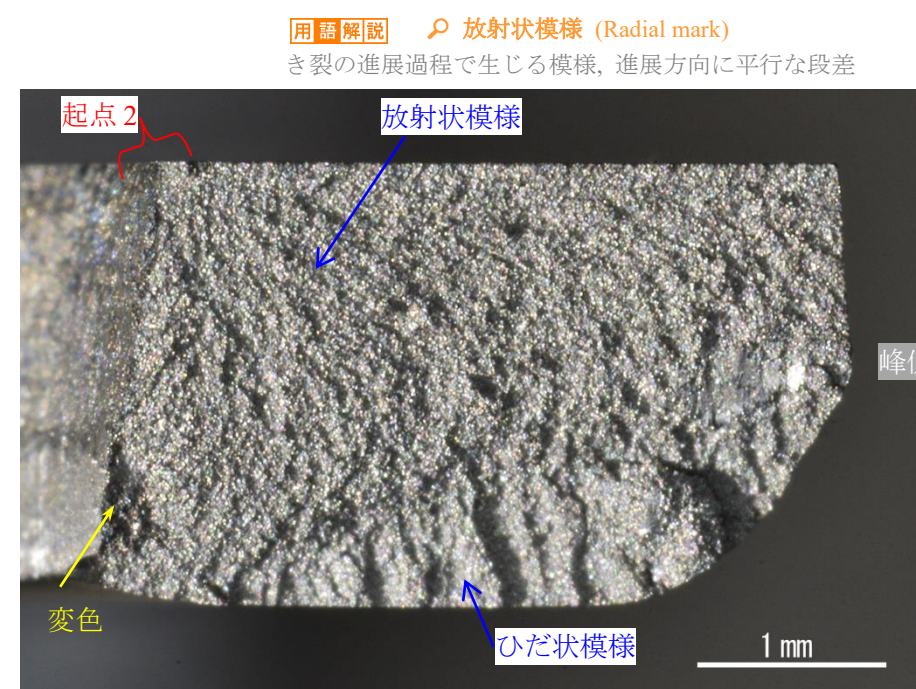
破面 峰側拡大（洗浄後） ×25
