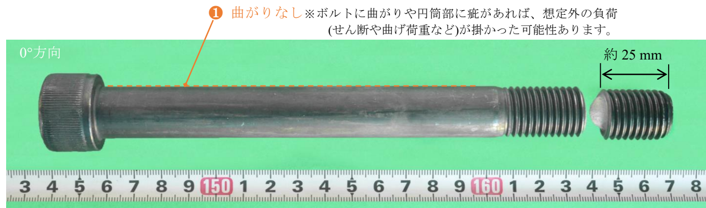
ボルトの全景 注) 角度は、後掲の破面観察での主起点を 0° とし、ボルト頭部から見て時計回りとした。 ×0.7
