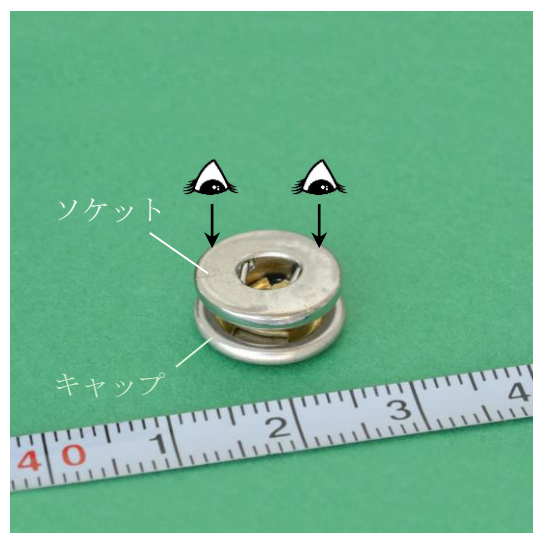
メス側ボタンの取り外し状況
