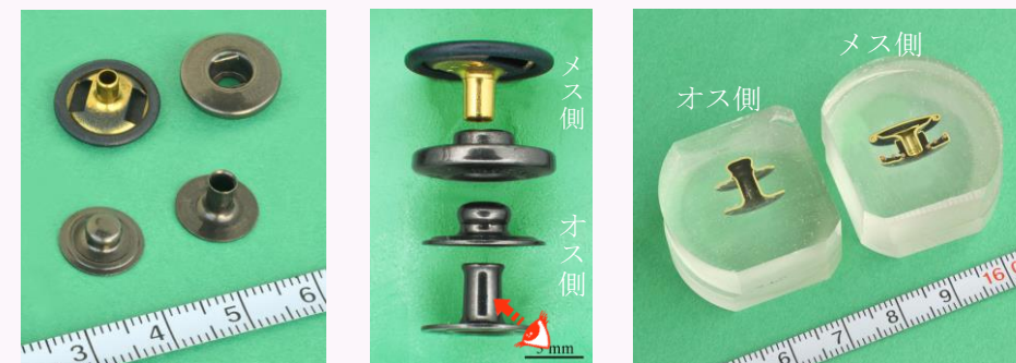
日本製ボタンの縦断面観察試料の作製状況
